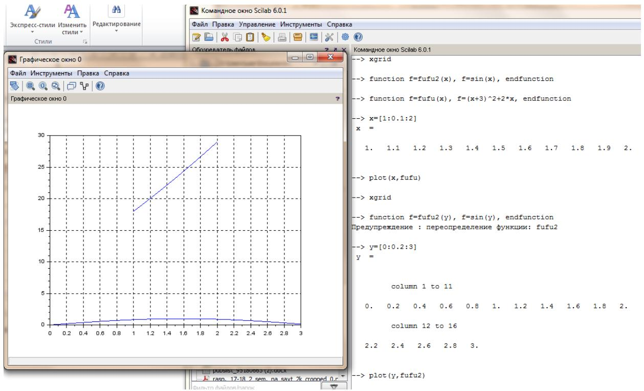
Таким образом, если мы имеем сходные функции на одном или близком интервале, то можем рисовать их в одном окне, что происходит автоматически. Однако в этом случае, поскольку интервалы разные и функции сильно отличаются, построим графики в разных окнах:
