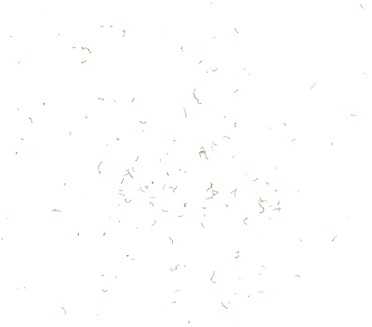
Рис. 9. Ячейка моделирования в конечный момент выдержки при T = 5200 К, содержащая разрозненные фрагменты углеродных цепочек.
